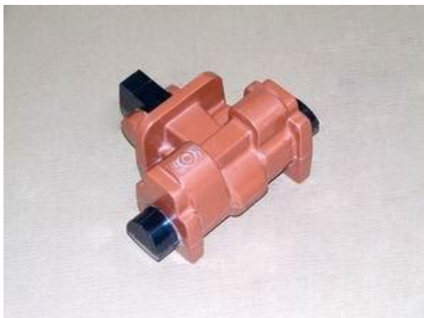
Оснастка из модельных пластиков
